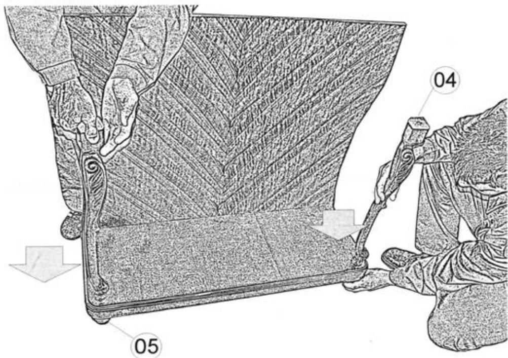
Установить ножку 04 гайкой в нижнем торце на шпильку опоры 05. Придерживая ножку 04 завернуть опору точеную по часовой стрелке до упора.
