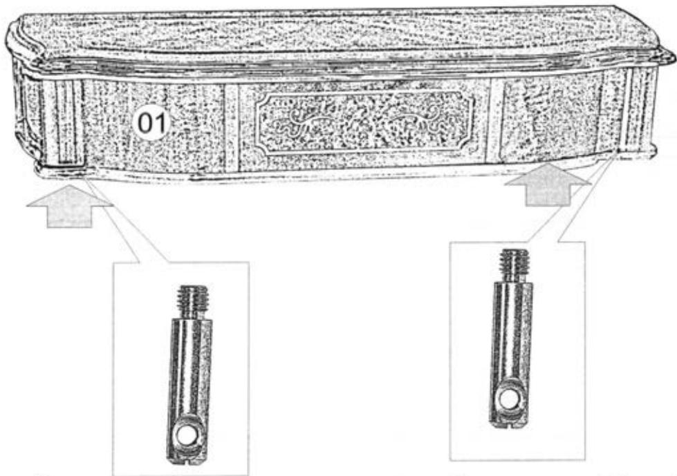
В отверстия стенки горизонтальной крышки в сборе 01 при помощи отвертки установить соединительные винты стяжки конической.
